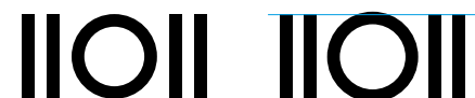
Bei runden und geraden Formen, die gleich hoch sind (links), erscheinen die runden Formen kleiner. Alle runden Buchstabenformen werden deswegen höher gehalten.
